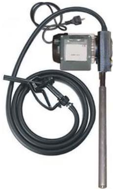
Indicata per nafta e gasolio (non per benzina e olio di colza). Motore monofase 230 V. Tubo di aspirazione lungh. m 1, con filtro e attacco per fusti G 2". Interruttore per accensione/spegnimento e m 0,8 di cavo con spina. Pistola di travaso e tubo di erogazione, lungh. m 4. Erogazione 58 l/min.
